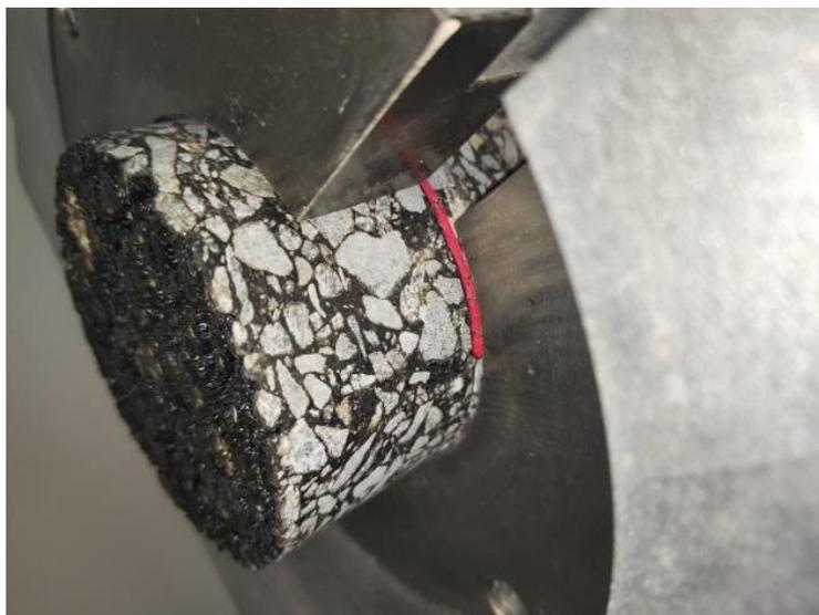
Рисунок 4 – Испытуемый образец, помещенный в устройство Лейтнера
