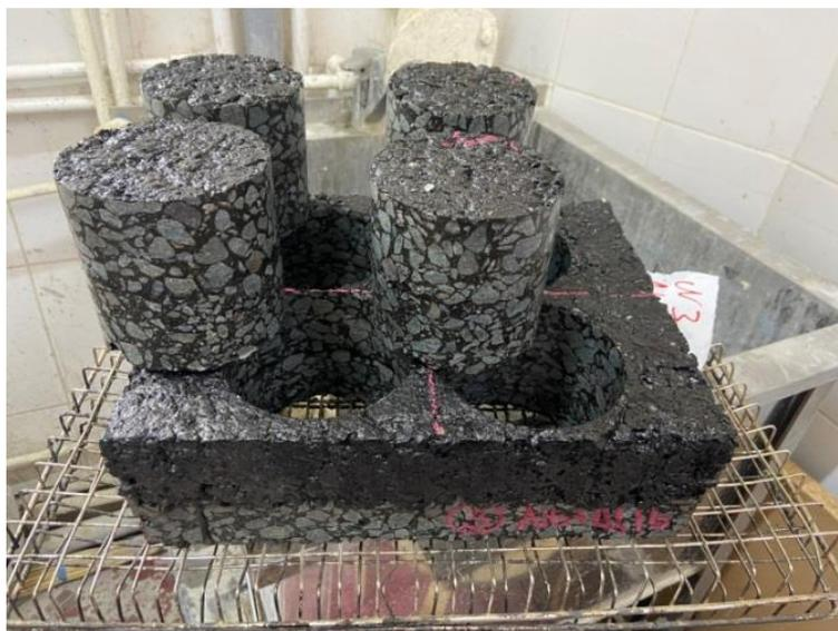
Рисунок 3 – Испытуемые образцы из лабораторной заготовки
